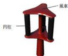
▲垂直軸型マグナス風力発電機（左）とマグナス効果（右）
